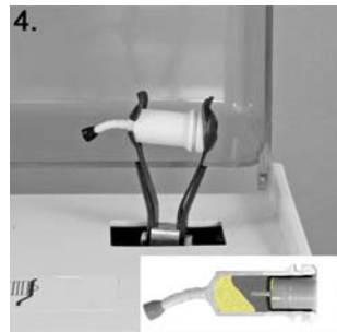
Die Kapsel in einen handelsüblichen Mischer einsetzen, den Deckel schließen und sofort mischen (ca. 4300 Schwingungen/Min.). Mischzeit: siehe entsprechende Gebrauchsanweisungsempfehlung)
